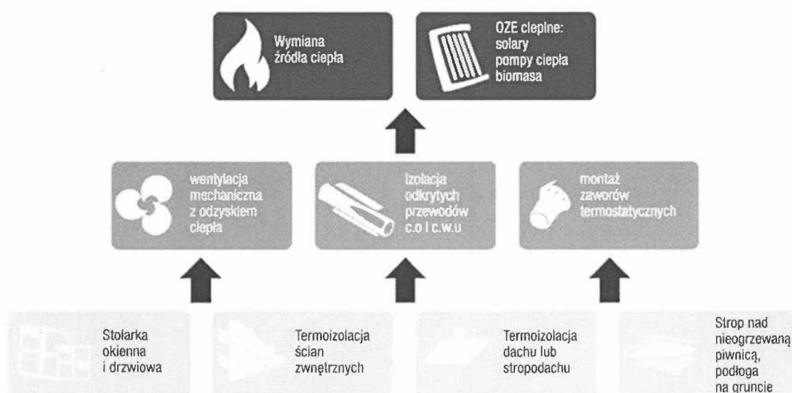
Rysunek 8. Etapy kompleksowej termomodernizacji budynku
